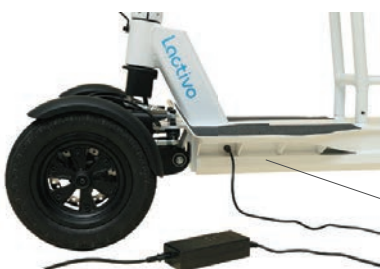
床下にリチウムイオン バッテリーを内蔵
